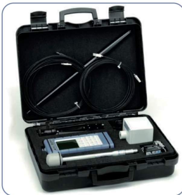
Fig. 30 - Kit di misura costituito dal palmare PMM8053 e dai sensori EHP50C, per le misure fino a 100 kHz, ed EP330 per frequenze fino a 3 GHz.
