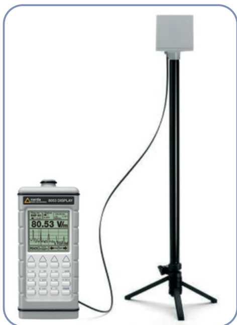
Fig. 30 - Kit di misura costituito dal palmare PMM8053 e dai sensori EHP50C, per le misure fino a 100 kHz, ed EP330 per frequenze fino a 3 GHz.
