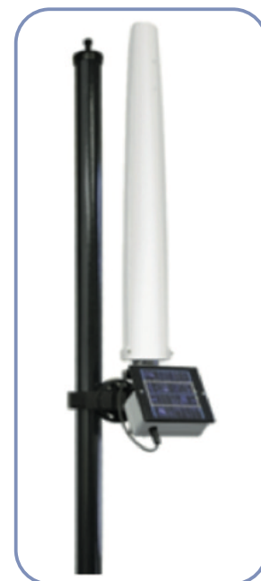
Fig. 31 - Sensore per la misura in continuo del campo elettrico e magnetico.
