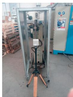
Fig. 4 Saldatrice con schermatura
